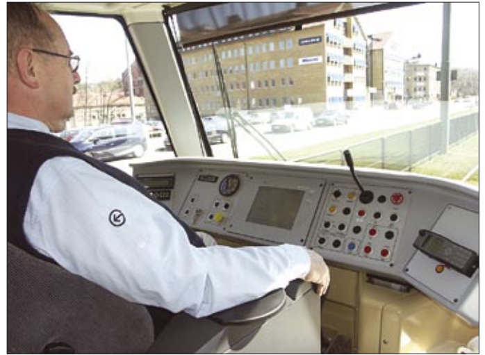
Förarbordet hör till det som ska åtgärdas inför kommande serieleveranser. I nuvarande utförande är närsikten för dålig.
