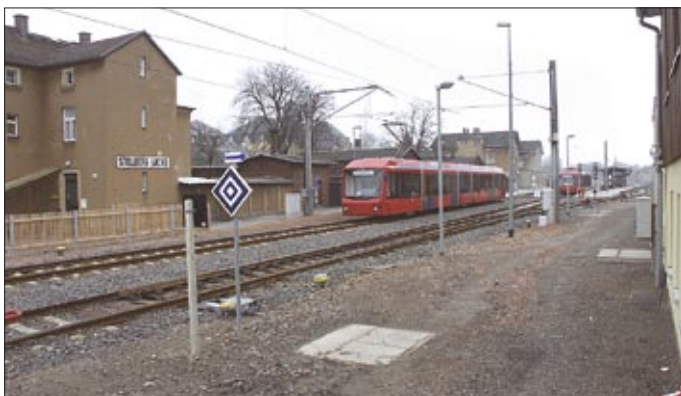
Mellan Chemnitz och Stollberg i Tyskland rullar dessa spårvagnar på en järnvägssträcka som elektrifierats (ca 700 V DC). Järnvägståg framförs i dieseldrift.
