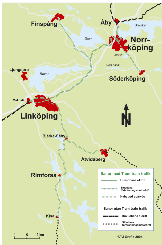
Det studerade systemet för duospårvagnstrafik i Östergötland. En förutsättning är att den nya järnvägsförbindelsen Ostlänken är öppnad för trafik så att den befintliga stambanan kan frigöras för duospårvagnstrafiken.
