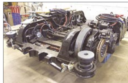
Motoriserad truck; observera det nedbyggda partiet mellan ramverk och hjul vilket medger det låga golvet i vagnen.
