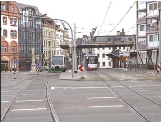
Strömmatningssystemen skiljer oftast mellan spårväg och järnväg, vilket dock kan bemästras om fordonen utrustas för flera matningssystem. Här i Zwickau är detta automatiskt löst eftersom motorvagnståget är dieseldrivet.
